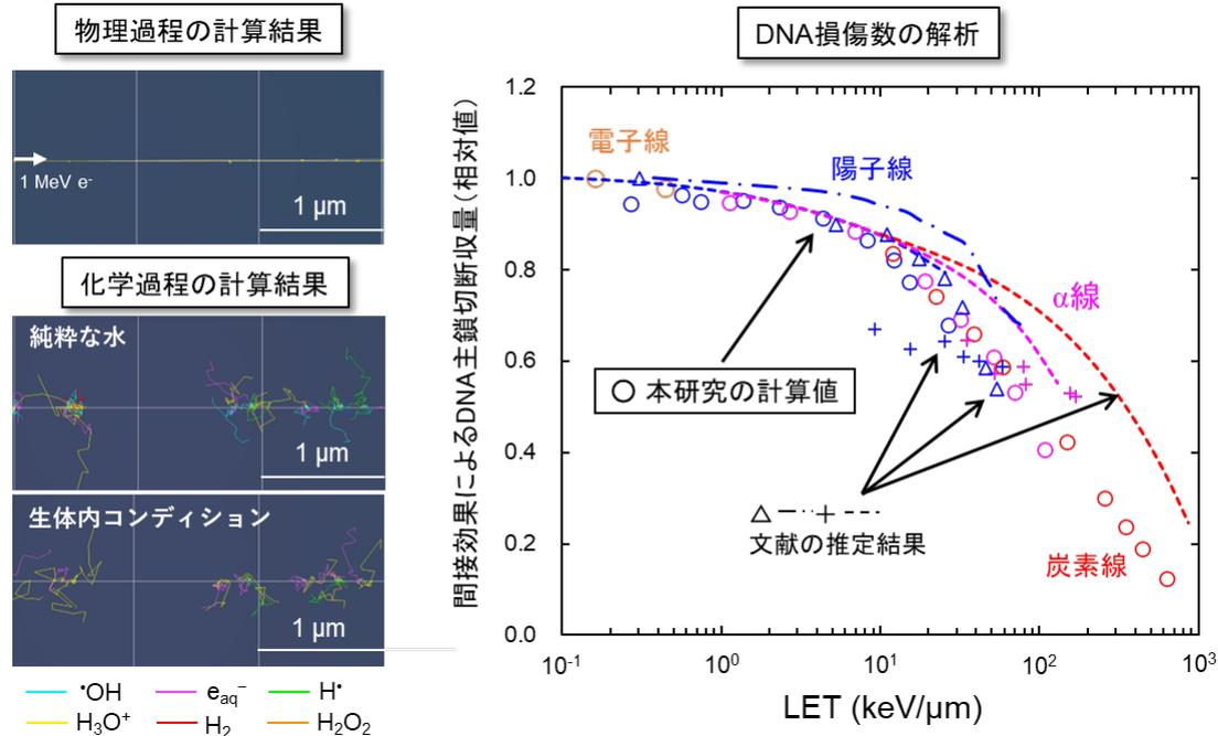
図 3 生命科学分野への応用として、DNA 主鎖切断<sup>13)</sup>数の解析を行いました。左上は  $1 \text{ MeV}^{14)}$  の電子線の飛跡、左中と左下は純粋な水中と生体内の分解生成物の挙動を追跡した結果です。右に、放射線の LET と間接効果の発生確率の関係を示します。
