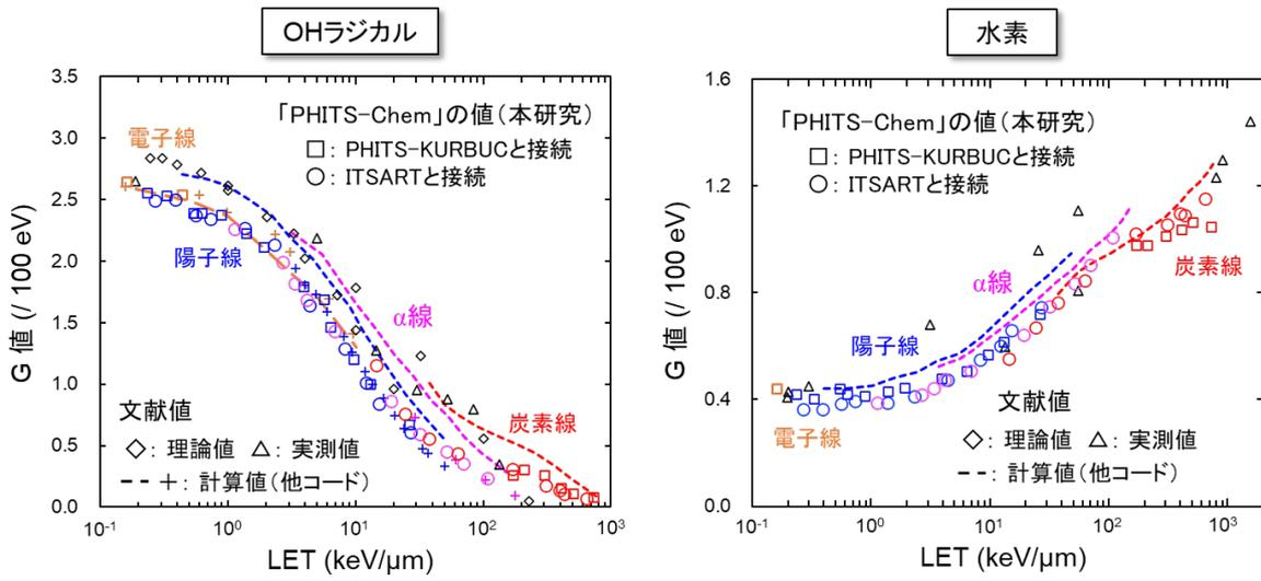
図 2 「PHITS-Chem」の検証として、照射後  $10^{-6}$  秒 (100 万分の 1 秒) のタイミングにおける G 値を計算し、文献値と比較しました。図 2(左)に OH ラジカル、図 2(右)に水素の結果を示しています。
