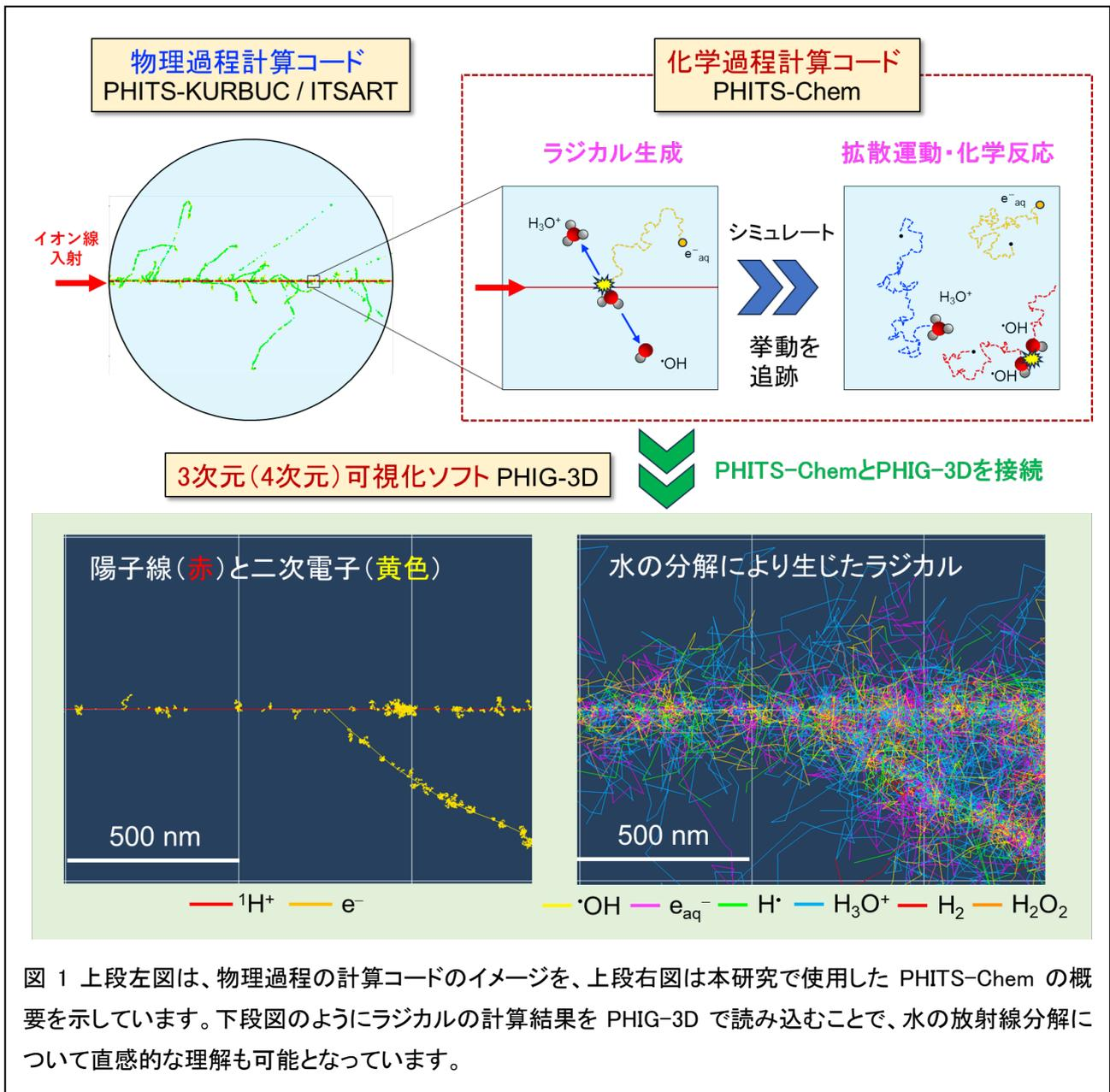
開発した「PHITS-Chem」の検証として、照射後  $10^{-6}$  秒(100 万分の 1 秒)のタイミングにおける陽子線、 $\alpha$  線、炭素線に対する OH ラジカルと水素の G 値<sup>11)</sup>を計算し、文献報告された実測値、理論値、他コードによる計算値と比較しました(図 2)。結果、良い一致を示すことがわかりました。さらに、PHITS に実装されている「ITSART」モデルは全てのイオン線の原子衝突反応をシミュレートすることが可能です。したがって、「ITSART」モデルと本研究で開発した「PHITS-Chem」を組み合わせることで、あらゆるイオン線により生じる水の分解生成物の挙動の評価が実現しました。
