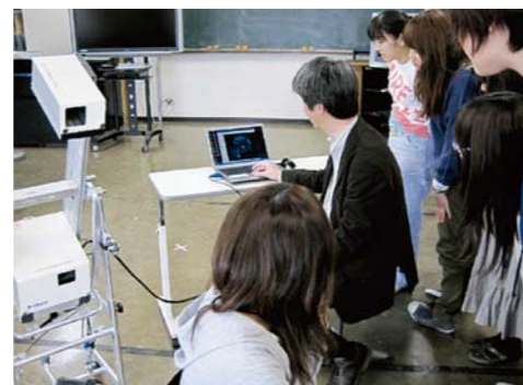
3次元曲面計測装置による車いすのバックレスト形状の測定
