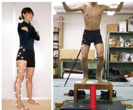
下肢に赤外線反射マーカをつけ、着地動作を赤外線力メラによりキャプチャーし、各関節の動きを三次元的にとらえている
