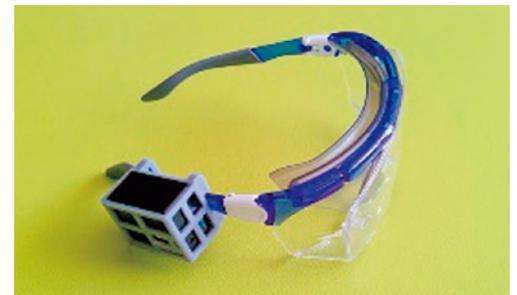
図 慣性センサを用いた頭頸部運動評価装置
