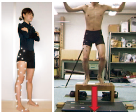
下肢に赤外線反射マーカ―をつけ、着地動作を赤外線カメラによりキャプチャーし、各関節の動きを三次元的にとらえている
