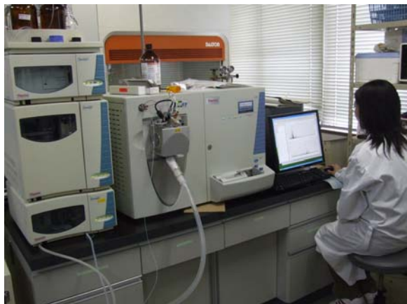
写真1 イオントラップ型定性用質量分析計（第4中央研究室）の実験風景
